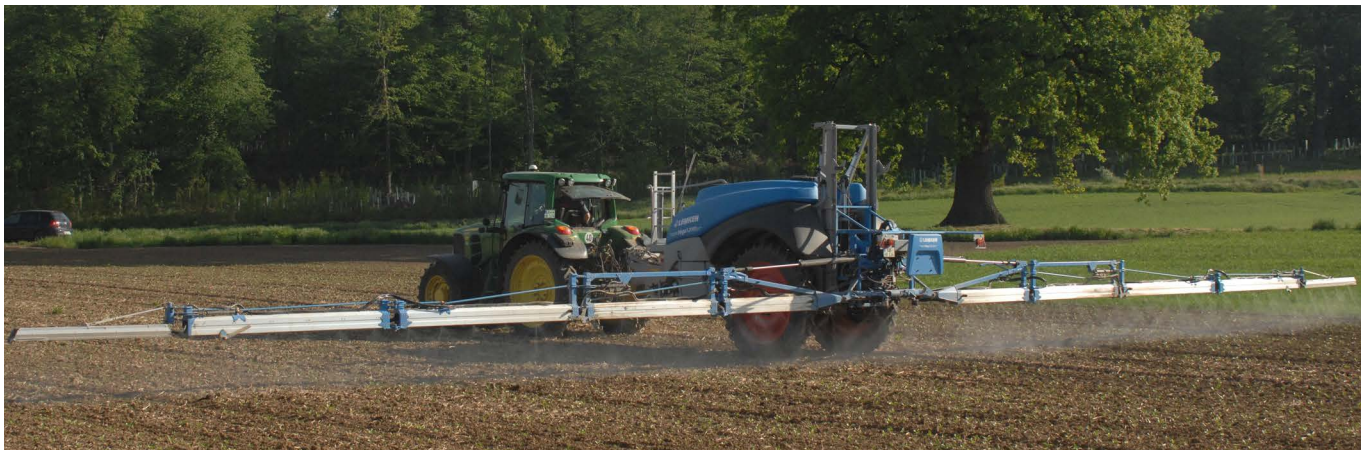
Mit zunehmender Fahrgeschwindigkeit und Gestängehöhe nimmt die Abdrift zu.
