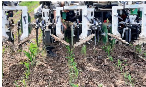
cken an der Reihe. Die Hackgeräte werden kameragesteuert präzise an der Kulturpflanze entlanggeführt. (Abb. 7)
