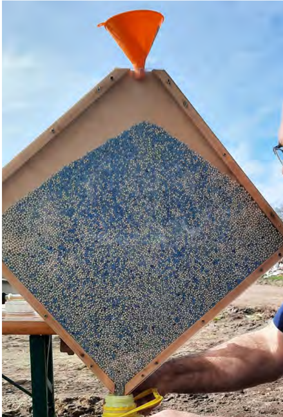
Abb. 2 Verteilung der Düngekörner nach Größe in einem Schüttkegel (blau: kleinere Körner, grau: größere Körner) Foto: Gesa Kohnke-Bruns
