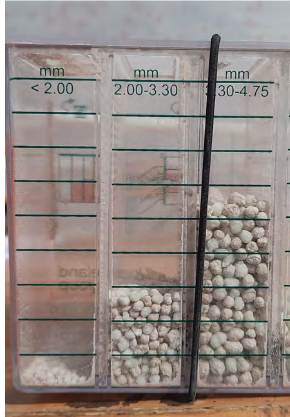
Abb. 3 Schüttelbox zur Bestimmung der Düngemittelkörnung – Feinstaub und sehr große Körner sollten möglichst einen kleinen Anteil haben. Foto: Gesa Kohnke-Bruns
